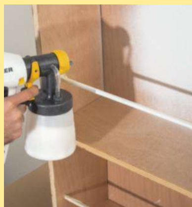
24 Protégez les tiges en aluminium (vissées à l'aide de supports de tringle) avec du ruban adhésif. Peignez le meuble et égrenez avant la seconde couche.
