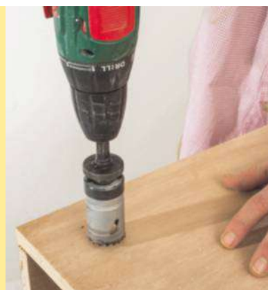
19 En façade, pour éviter d'avoir à placer des boutons ou des poignées, percez à la scie cloche une poignée creuse (Ø 35 mm), dont les arêtes seront adoucies au ponçage.
