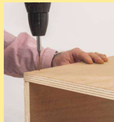
22 Assemblez les niches à intégrer dans la paroi. Utilisez le même dispositif de centrage et de guidage de la perceuse pour mettre en place les tourillons. Le serrage peut être effectué par vissage (vis 4 x 45 mm) car les têtes de vis ne seront pas visibles une fois les niches mises en place à travers la paroi.
