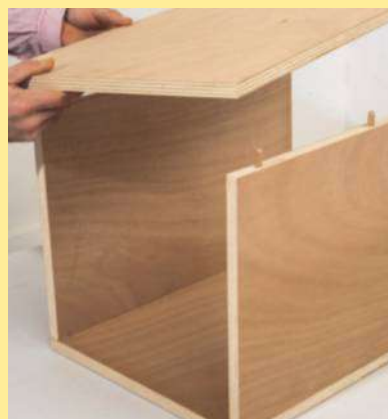
22 Assemblez les niches à intégrer dans la paroi. Utilisez le même dispositif de centrage et de guidage de la perceuse pour mettre en place les tourillons. Le serrage peut être effectué par vissage (vis 4 x 45 mm) car les têtes de vis ne seront pas visibles une fois les niches mises en place à travers la paroi.
