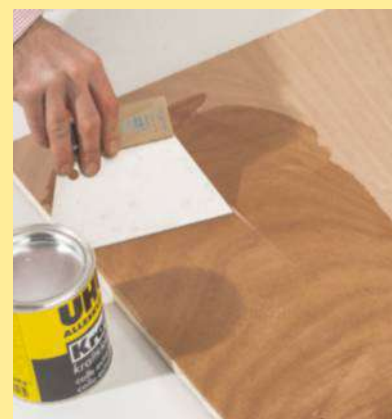
25 Le plan de travail du bureau est recouvert de simili cuir. Étalez de la colle Néoprène à la spatule crantée sur les deux faces à assembler (bois et cuir).
