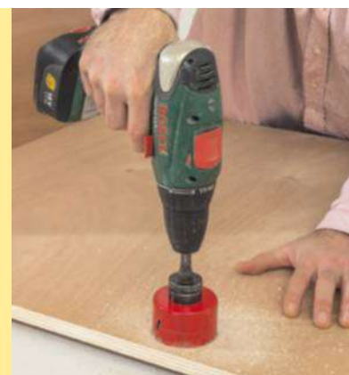
20 Percez également à la scie cloche (Ø 68 mm) le haut du dos de l'élément central fixe pour poser un passe-câbles.
