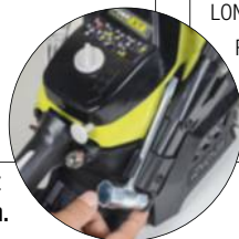
La clé à bougie a ici son emplacement spécifique, à portée de main.
