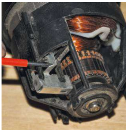
4/ Les nouveaux charbons ont été récupérés sur un souffleur. Le montage est similaire mais les porte-charbons sont fermés sur le dessus et fixés par des pattes logées dans le carter.
