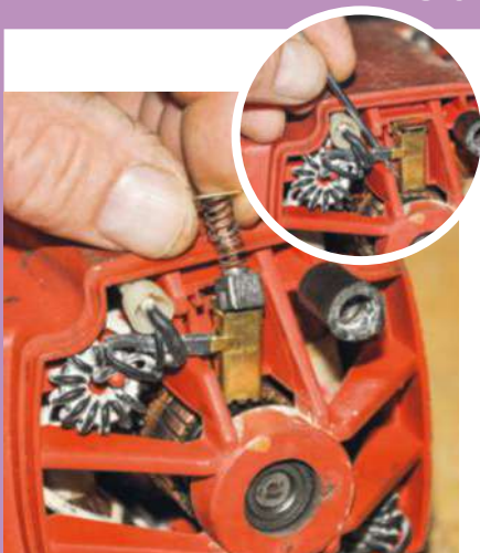
3/ Le parcours d'un fil « secteur » : il part du connecteur (blanc), traverse la bobine torique (antiparasite) pour se brancher sur la cosse du porte-charbon, ici tiré pour dégager le charbon usé.
