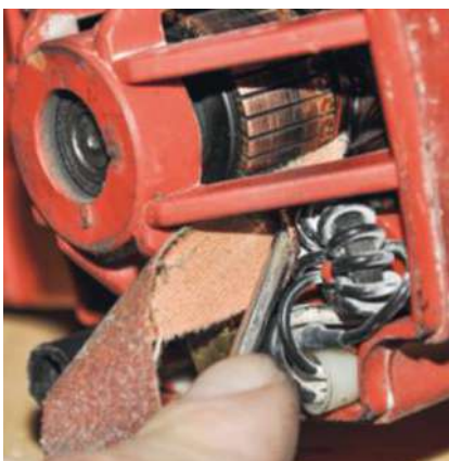
7/ Avant de replacer les porte-charbons, glissez un abrasif sur les lames du collecteur, en pressant avec un tournevis, tout en faisant tourner l'arbre d'induit à la main.
