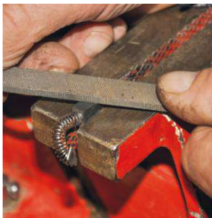
6/ L'ensemble (charbon, tresse, plaquette, ressort) est prélevé sans les dissocier. Le charbon est rectifié symétriquement à la lime en respectant les cotes de l'ancien (prises au pied à coulisses).
