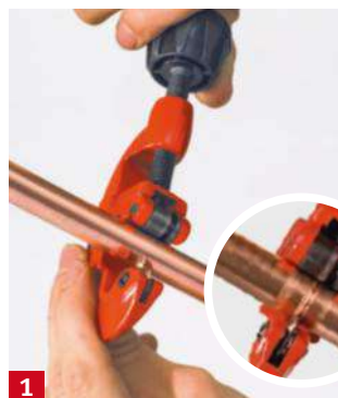
1 Serrez la poignée pour enfoncer légèrement la molette tranchante et faites tourner l'outil autour du tube.
