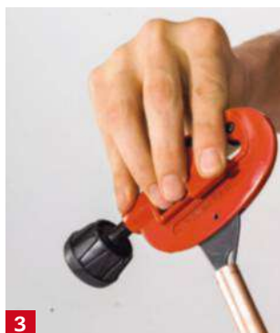
3 Utilisez la lame triangulaire pour ébarber l'intérieur du tube et éliminer ainsi tous les copeaux restants.
