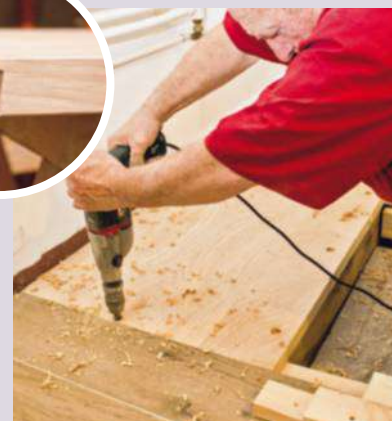
12 Percez (perceuse équipée d'une fraise à encastrer) le plateau, puis fixez-le sur le cadre périphérique et faites disparaître les têtes de vis dans l'épaisseur du bois.
