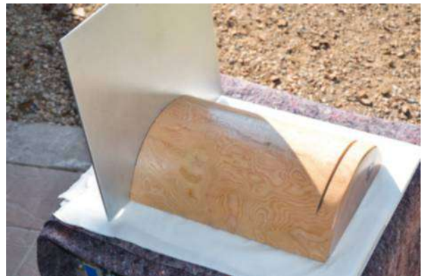
Le rondin a été écorcé, raboté et verni. Les pieds en aluminium ont été poncés au papier très fin jusqu'à obtenir une surface dépolie.
