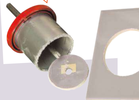
20 Contournez un tuyau, grâce à une encoche en U réalisée avec une scie cloche (trépan diamanté), au diamètre du tuyau + 5 mm. Terminez par deux traits de meuleuse à partir du bord.
