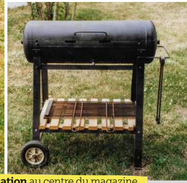
La cuve a été découpée avec une meuleuse d'angle équipée d'un disque abrasif. Les deux parties ont ensuite été reliées par des charnières à piano.
