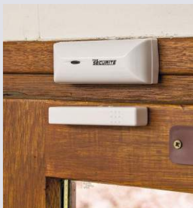
9 Fixez le transmetteur sur le châssis fixe (fenêtre) ou le cadre de la porte et la bande magnétique sur l'ouvrant. Suivez les instructions pour activer le mode « auto-code ».
