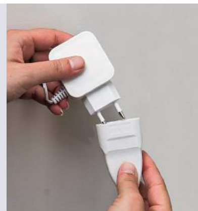
7 Branchez l'alarme pour l'activer. Selon la configuration des lieux, il peut être nécessaire de prévoir une rallonge électrique, car le câble fourni est très court.
