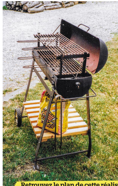
La cuve a été découpée avec une meuleuse d'angle équipée d'un disque abrasif. Les deux parties ont ensuite été reliées par des charnières à piano.
