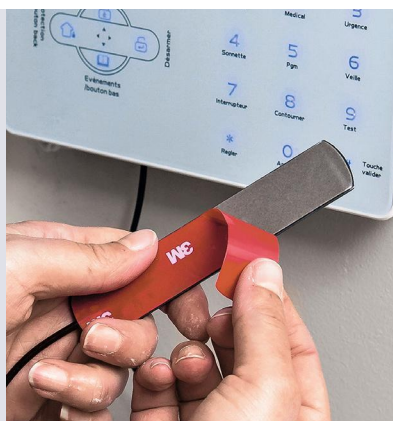
6 L'antenne GSM se fixe au mur à l'aide d'un adhésif double face (fourni). Fixez l'extrémité de l'antenne en hauteur dans une zone bien dégagée pour optimiser la réception GSM.
