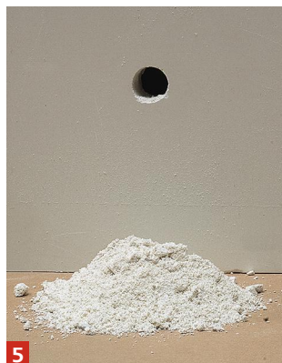
5 La poussière est blanche, fine et « colle » au foret : il s'agit d'un mur à base de plâtre (carreaux ou plaques).
