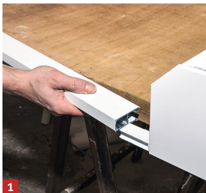
1 Insérez une première coulisse sur l'un des tenons jusqu'à ce qu'elle arrive en butée. Répétez l'opération pour la seconde coulisse.
