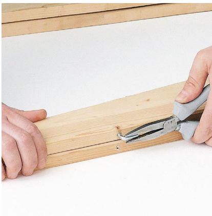
7/ À 24 cm du bas du pied, vissez à la pince un piton à bois en L après perçage d'un avant-trou (Ø 1,5 mm). Il retiendra l'extrémité libre du compas. Une vis à tête bombée aurait pu faire l'affaire.
