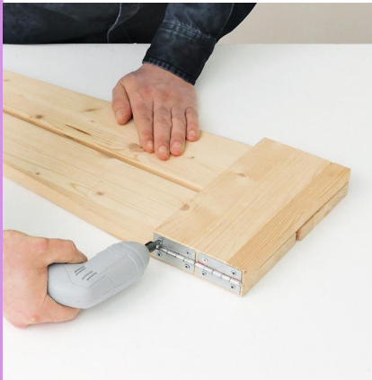
3/ Même technique pour l'autre pied, en les alignant parfaitement. Chaque demi-tréteau se compose ainsi de trois pièces : une traverse et deux pieds qui se rabattent horizontalement.
