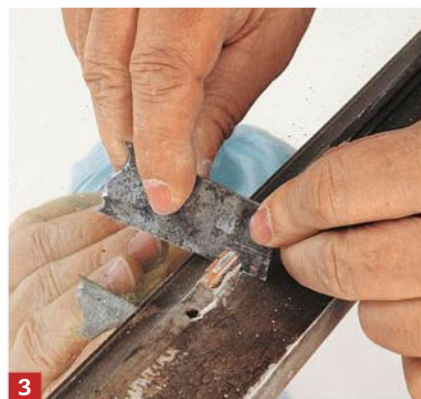
3 Comparez régulièrement l'entaille du fer avec le dessin de la moulure originale. Cela vous permettra de minimiser les différences qui pourraient surgir.
