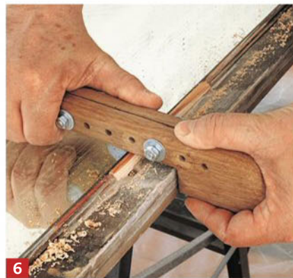
6 La baguette collée, commencez à tailler celle-ci avec le tarabiscot. Tirez fermement vers vous le tarabiscot, la crosse étant placée le long du cadre en bois.
