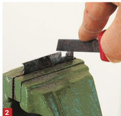
2 Placez la lame de fer dans un étau pour travailler à la lime après avoir dégrossi le profil à la meule. Utilisez une lime ronde « queue-de-rat » à denture fine.
