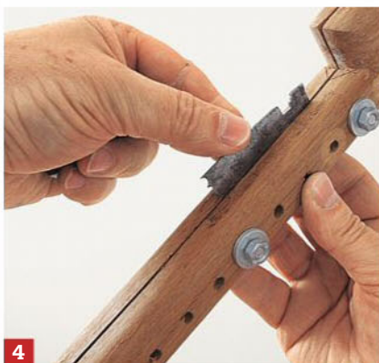
4 Le travail terminé, placez le fer dans la fente du tarabiscot, sans serrer les écrous. Placez l'outil sur la moulure pour déterminer la distance entre la lame et la crosse.
