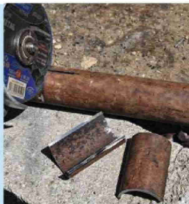
5 Pour le maintien de la main courante, découpez dix supports de 80 mm de long (un pour chaque montant) obtenus en fendant cinq sections de tube Ø 42 mm.
