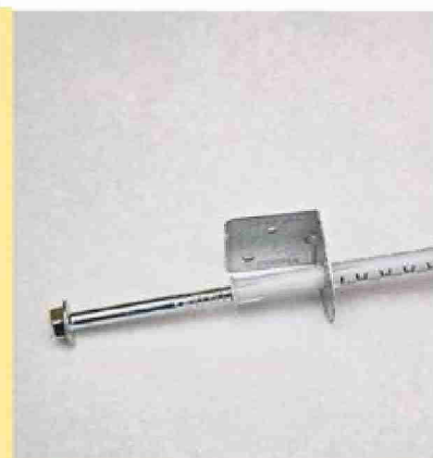
21 Pour des cloisons de grande hauteur (> 3 m), on utilise des appuis spécifiques. Il suffit de percer l'isolant et le mur, et de visser l'équerre au niveau des montants.
