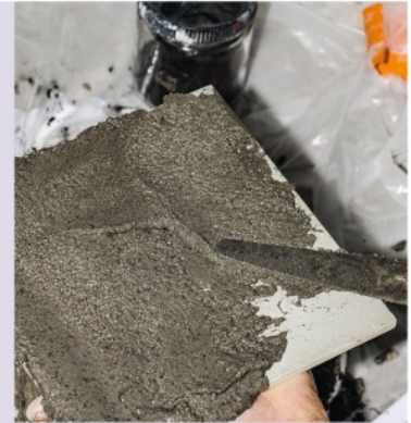
8 Chaque test se fait sur un carreau de faïence (ou autre support) numéroté. La teinte s'éclaircit en séchant et il faut plusieurs jours pour avoir une idée précise de la nuance finale.
