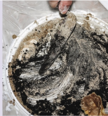
7 Profitez des étapes préparatoires pour effectuer des essais de pigmentation de la chaux. Notez soigneusement les dosages des différents ingrédients.
